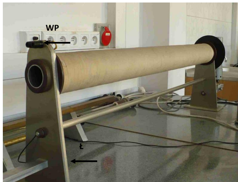
Rys. 3 Fotografia solenoidu. WP – wejścia prądowe, ł – główna łaśa optyczna.
