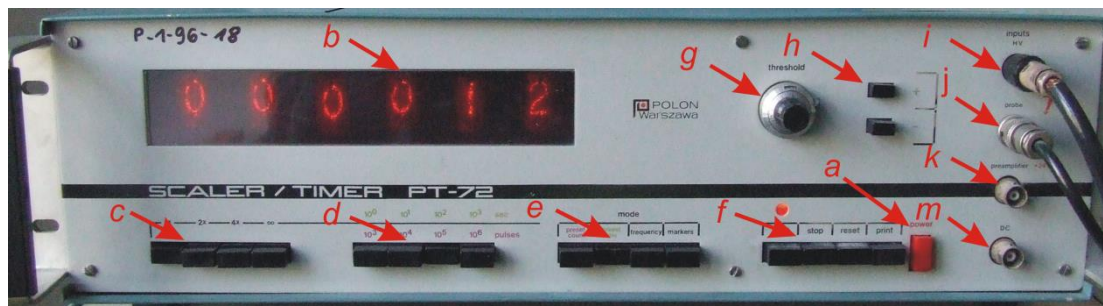
Rys. 5. Panel przedni przelicznika impulsów PT-72
