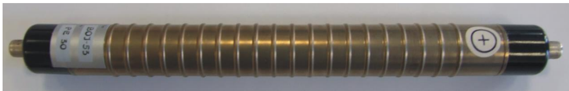
Rys. 3. Licznik Geigera-Müllera: typ BOJ 53
