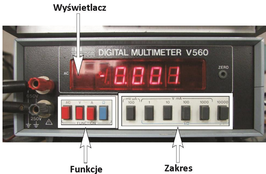
Rys. 6. Multimetr cyfrowy V560 z zaznaczonymi elementami sterowania.
