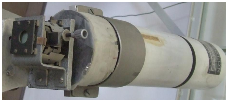
Rys. 7 Scyntylator NaI z fotopowielaczem. Z przodu widoczna jest przesłona z otworem oraz filtr niklowy.
