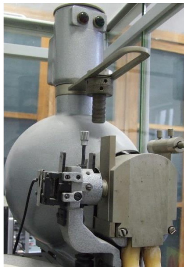
Rys. 4b Lampa rentgenowska: lewy panel- widok z góry, środkowy panel- widok z boku, prawy panel – miliamperomierz rentgenowskiej (1), dioda sygnalizacyjna zasilania (2), dioda sygnalizacyjna wysokiego napięcia (3).
