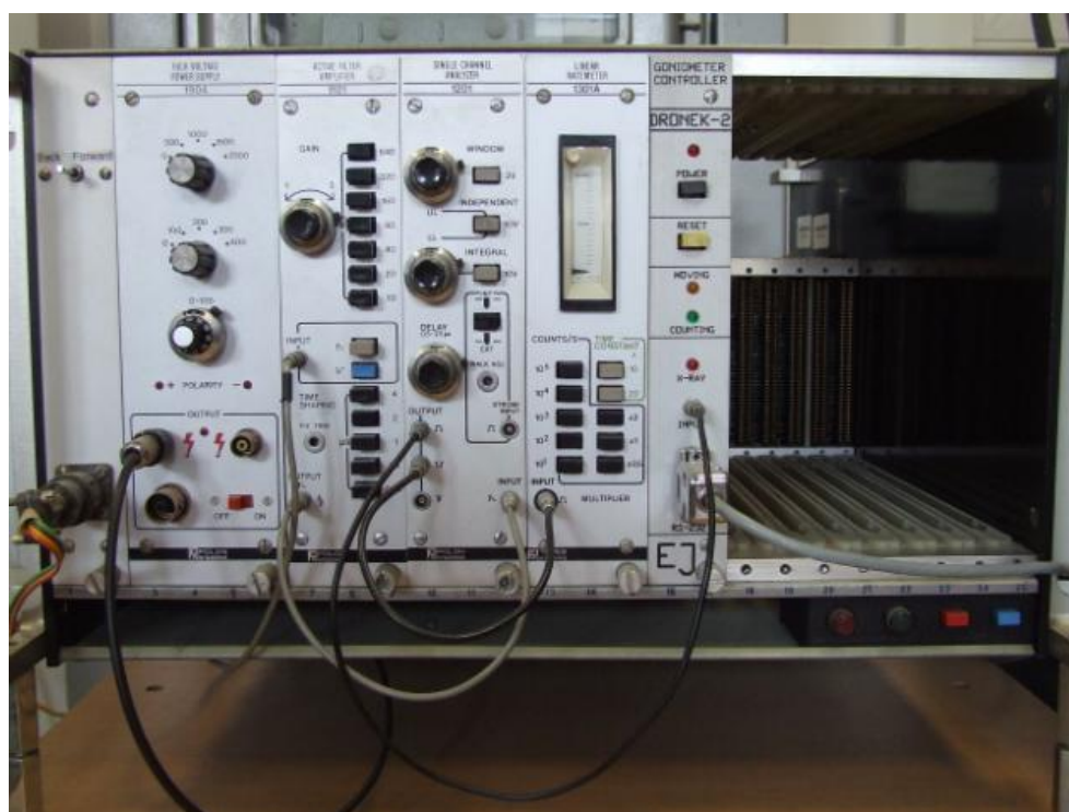
Rys. 9 Kasetę CAMAC z urządzeniami rejestracji natężenia promieniowania rentgenowskiego.
